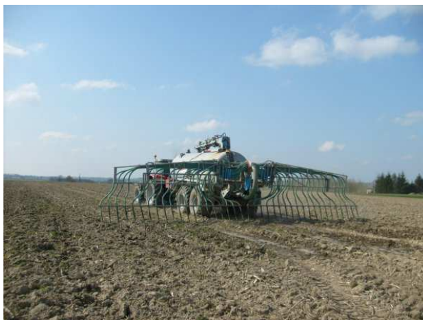
Figure 1 : Epandage du digestat et du lisier avec un tonneau type « pendillard »
