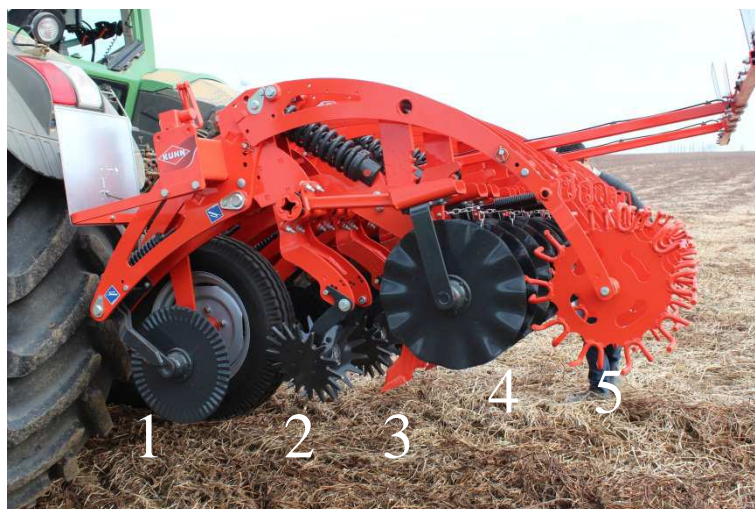
Éléments d'un strip-tiller (source : C. Roisin, CRA-W)
