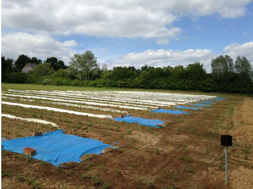
Vue sur un essai situé dans la commune d'Ittre. Sous les bâches bleues, des entonnoirs et des bacs récolteurs permettent d'enregistrer les volumes d'eau ruisselés ainsi que les quantités de terres érodées. (Photo CIPF, 1/6/15)
