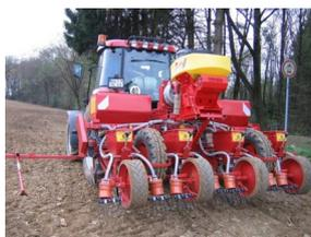
De par sa conception, le semoir Pöttinger Arosem permet l'implantation simultanée du maïs et du sous-semis (graminée ou légumineuse). En fonction de son développement, le sous-semis peut être implanté sur une à cinq lignes entre les rangs de maïs.
